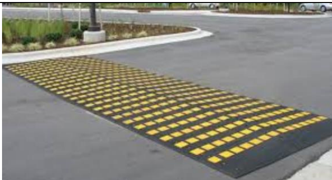
Παράδειγμα ύβωσης επί της οδού
