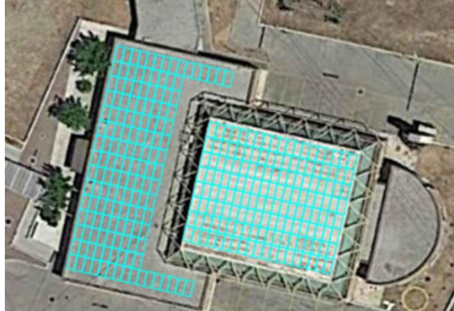
Εικόνα 3.4 Χωροθέτηση Φ/Β συστημάτων στην κολυμβητική δεξαμενή Αγίων Αναργύρων
