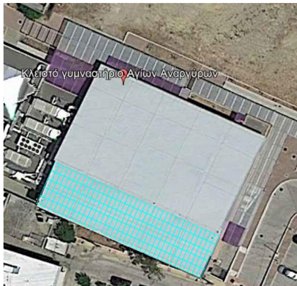
Εικόνα 3.3 Χωροθέτηση Φ/Β συστημάτων στο κλειστό γυμναστήριο Αγίων Αναργύρων
