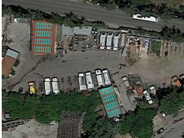
Εικόνα 3.6 Χωροθέτηση Φ/Β συστημάτων στο χώρο στάθμευσης του δημοτικού στόλου
